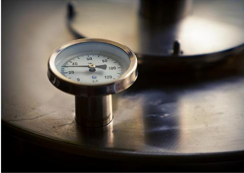
В кубах от 12 литров по умолчанию предусмотрен биметаллический термометр, а также шаровый кран для слива барды или отходов дистилляции. Также в данных кубах предусмотрено подключения барботера для перегонки фруктовых и зерновых заторов.
