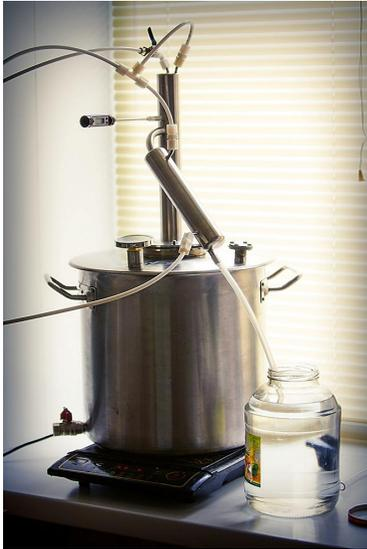
Под кожухом проточного холодильника находится 7 трубок, которые охлаждают пары спирта, таким образом, холодильник справляется с потоком дистиллята до двух литров в час, то есть, струя идет чуть тоньше обыкновенной спички.
